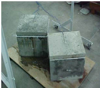
Figura 4. Termoacumuladores com termopares
