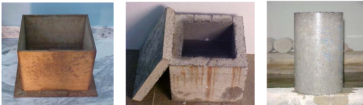
Figura 1: Fôrma, termoacumulador e corpo de prova contendo borracha
