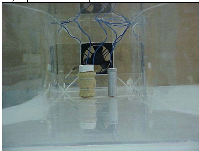
Figura 2 – Cápsulas contendo água e gelo em seu interior sob fluxo de ar em um mini túnel de vento
