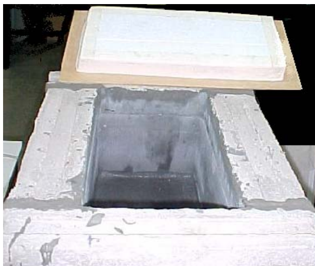
Figura 3 – Termoacumulador com a tampa de vedação
