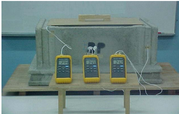
Figura 6 – Termoacumulador durante procedimento experimental
