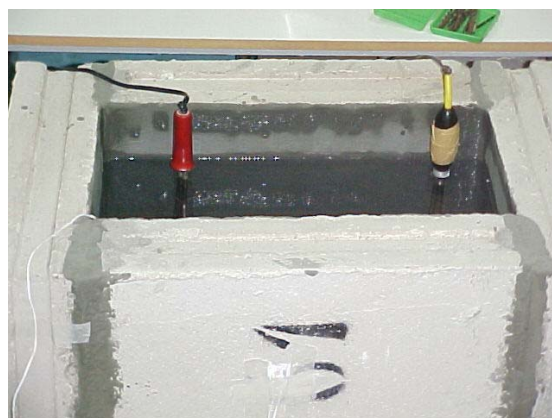
Figura 5 – Aquecimento da água com as resistências
