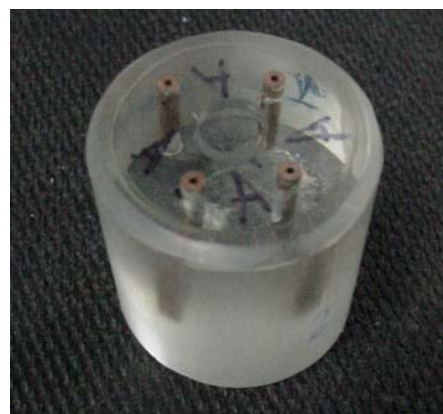
Figura 5. Amostra para medição do diâmetro interno
