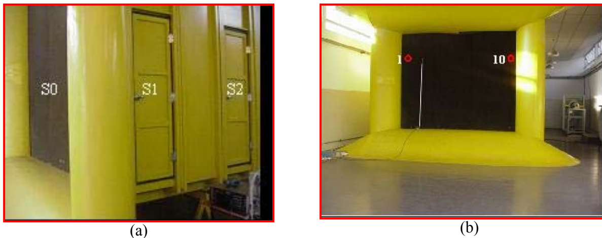
Figura 5: (a) Posição das seções onde foi feito o mapeamento transversal no interior da câmara de tranquilização, (b) Suporte usado para o mapeamento, posicionado na seção S0.
