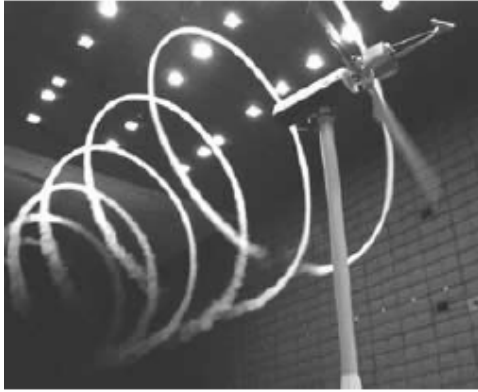
Figura 1 – Formação da rotação na esteira para uma turbina de diâmetro de 10 m, visualizada com fumaça (Dahl et al. , 1999).
