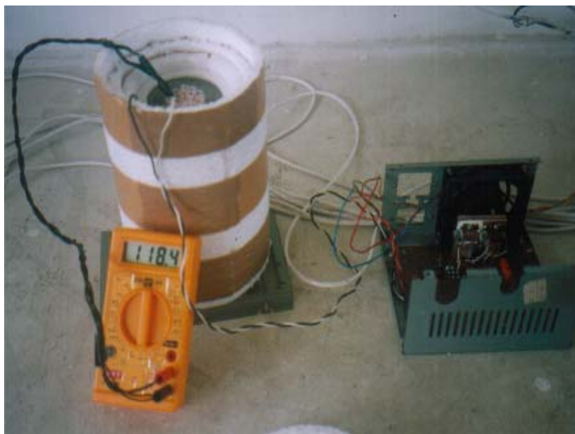
Figura 4. Montagem do Controlador, Cilindros e sensores
