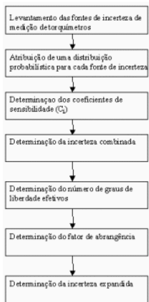
Figura 1 – passo a passo para expressão da incerteza de medição de torquímetro com confiabilidade de aproximadamente 95%.
