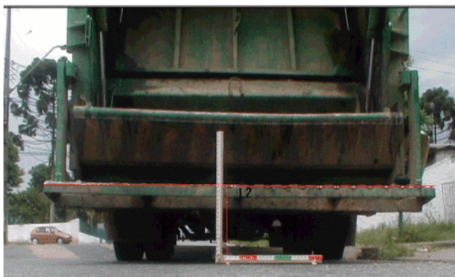
Figura 5 – Levantamento das dimensões do caminhão
