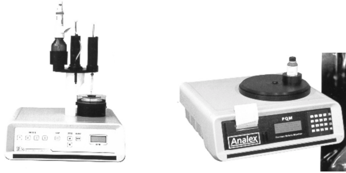
Figura 1. Separador de Partículas RPD e Quantificador de Partículas Magnéticas PQM.
