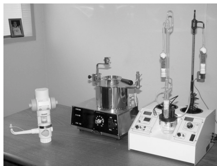
Figura 4. Bureta Digital (verificação do TAN e TBN), Aparelho para verificação do Ponto de Fulgor e Combustão e Aparelho para verificação do teor de água (Karl Fischer).
