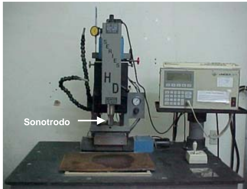
Figura (1). Equipamento usado nos ensaios de usinagem por abrasão ultrasonora.
