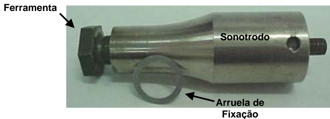
Figura (2). Conjunto ferramenta de usinagem, sonotrodo e arruela
