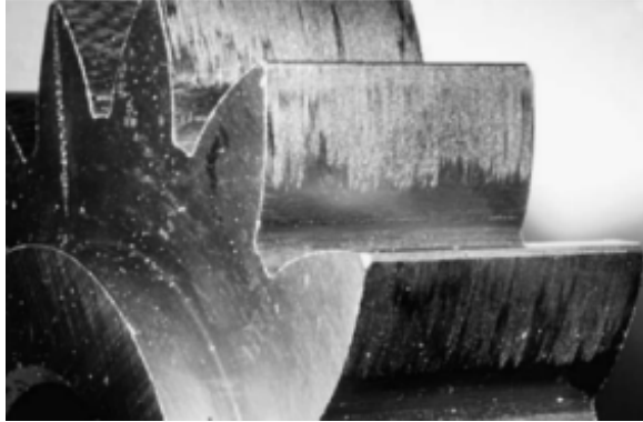
Figura 4. Engrenagem FZG padrão – desgaste ‘ scuffing ’
