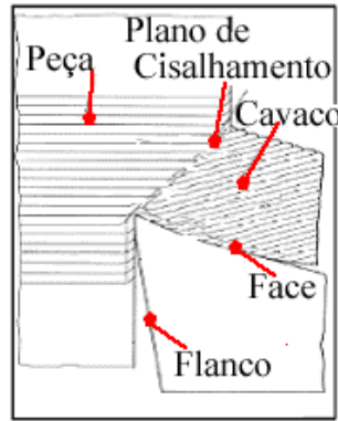
Figura 3. Par tribológico cavaco-ferramenta
