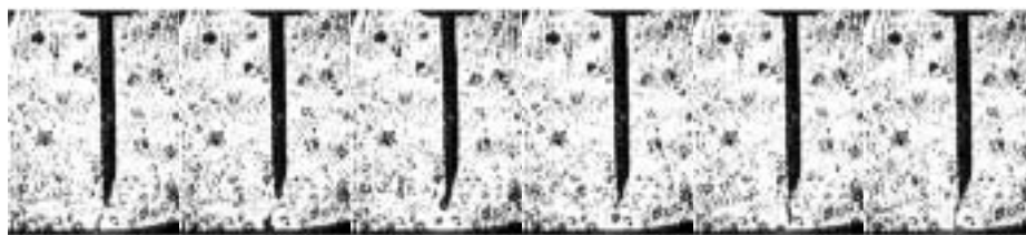
Figura 10 – Transferência mista Goticular com alongamento/Goticular rotacioanal.
