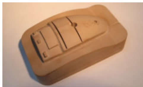
Figura 8 - Inserto do mouse após a usinagem
