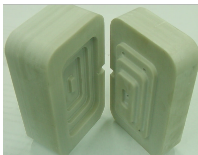
Figura 5. Insertos da pirâmide após a usinagem
