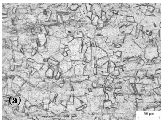
Figura 2. Microestrutura do aço AISI 316L como recebido (não solubilizado). (a) sentido de laminação 100x (b) sentido perpendicular à laminação 100x.
