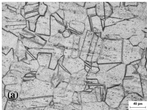
Figura 5. Microestrutura do aço AISI 316L solubilizado e sensitizado. Sentido de laminação. (a) microscopia óptica 100x. (b) microscopia eletrônica 1332x.
