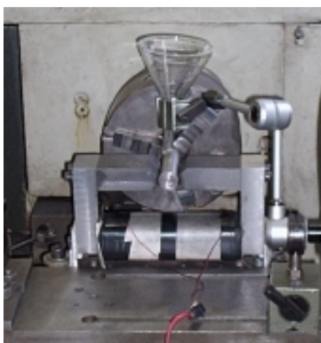
Figura 3 – posicionamento do corpo de prova no dispositivo construído.
