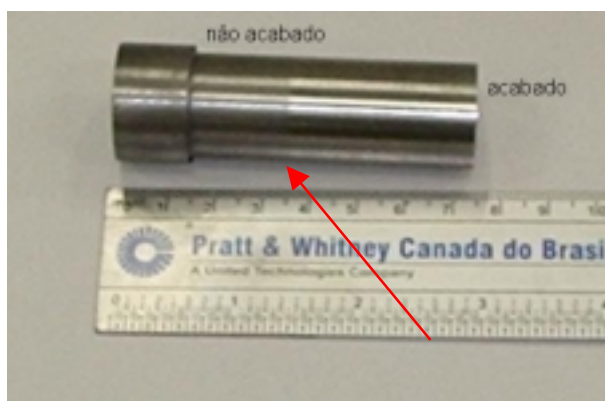
Figura 5 – corpo de prova após ensaio. A seta indica o limite de da zona de trabalho.
