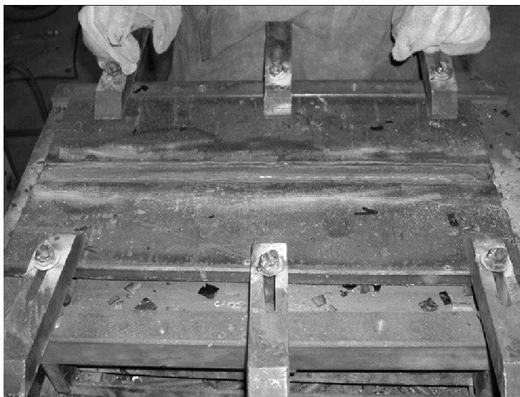
Figura 1 – Corpo de prova soldado, ainda na bancada de fixação.
