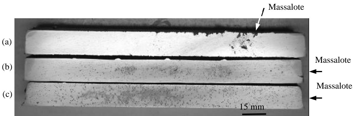
Figura 4. Localização do massalote com relação a peça. Porosidades na seção transversal para as peças 1,5 x 7,0 x 20,0 cm.
