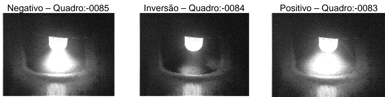
Figura 3 – Sequência de quadros utilizados para ratificar a identificação da polaridade do arco (Tempo entre quadros = 4ms - arquivo 03857.mcf )
