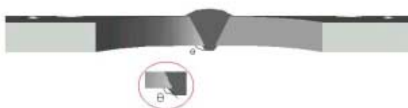
Figura 2 - Ilustração esquemática do ângulo de convexidade medido na raiz da solda.
