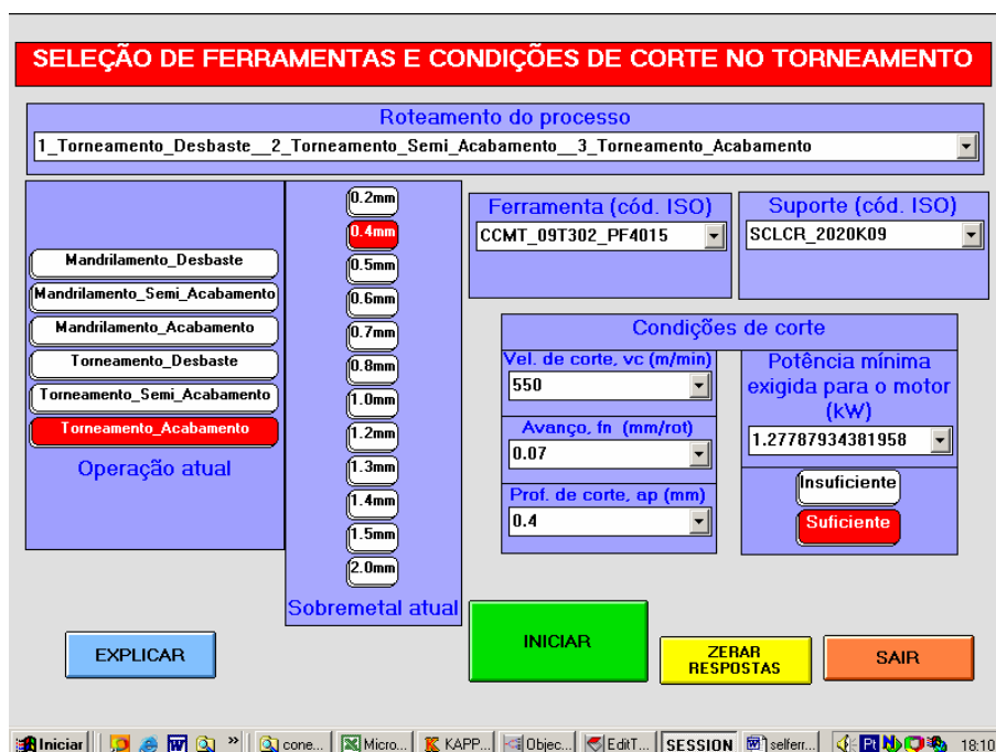
Figura 5. Tela de entrada/saída para torneamento da feature eixo cilíndrico
