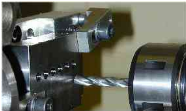
Figura 3. Broca posicionada para a furação, para MQF aplicado pelo interior da ferramenta
