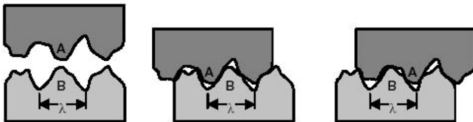
Figura 6. Influencia da rugosidade na repetibilidade de posicionamento (Culpepper, 2000)
