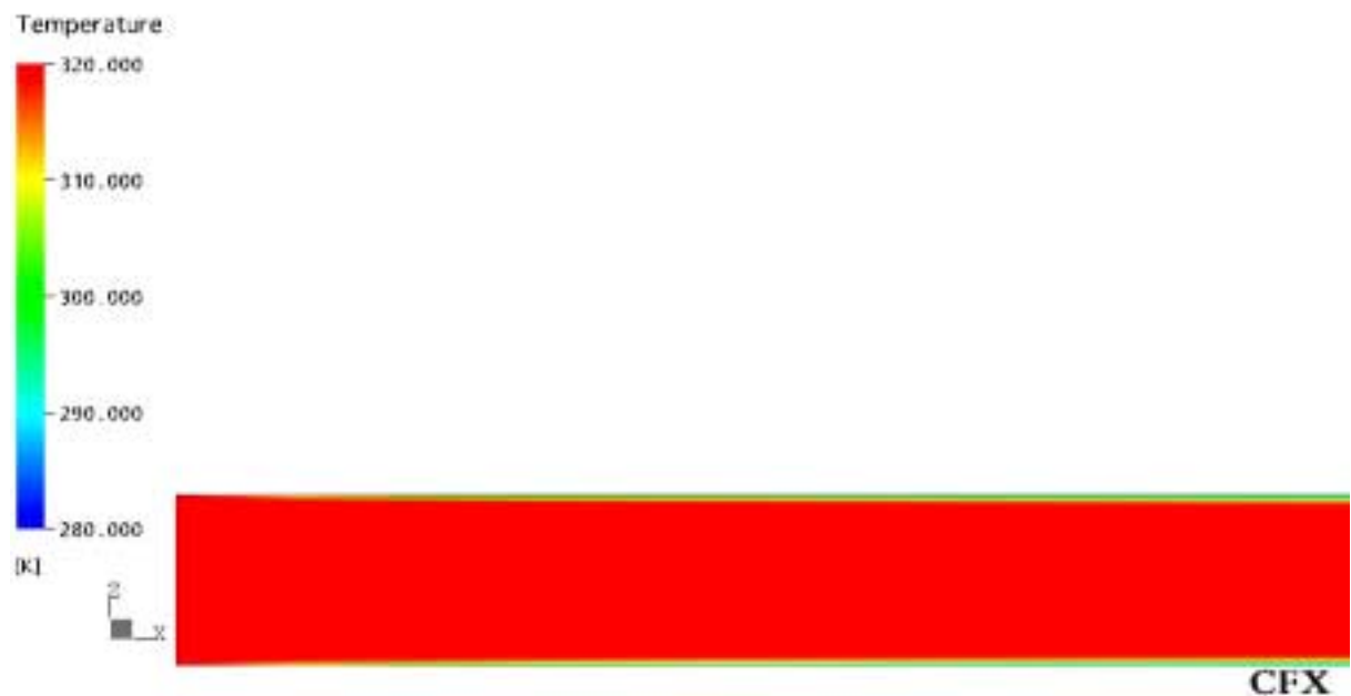
Figura 7. Distribuição de temperatura do óleo numa região próxima a entrada do duto.
