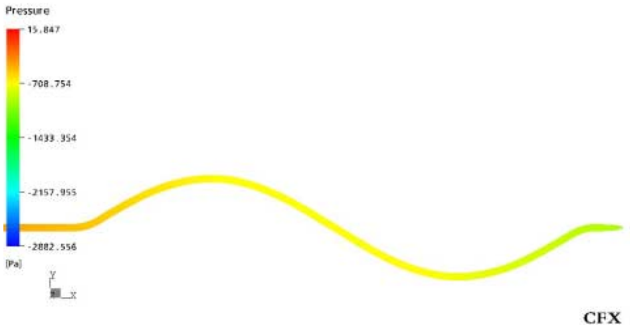
Figura 8. Distribuição de pressão do óleo na região curva do duto (senóide).
