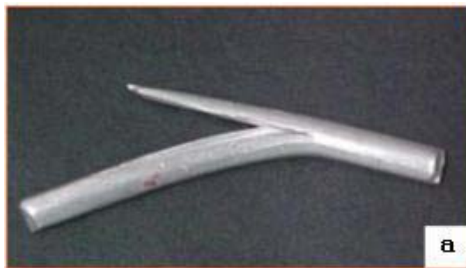
Figura 6- Em (a): detalhe de um defeito ocorrido que se tornou nítido durante o processo de trefilação, que segundo avaliação esta ligado a problemas relacionados a solidificação do metal, bolhas de ar formadas no interior do metal solidificado.
