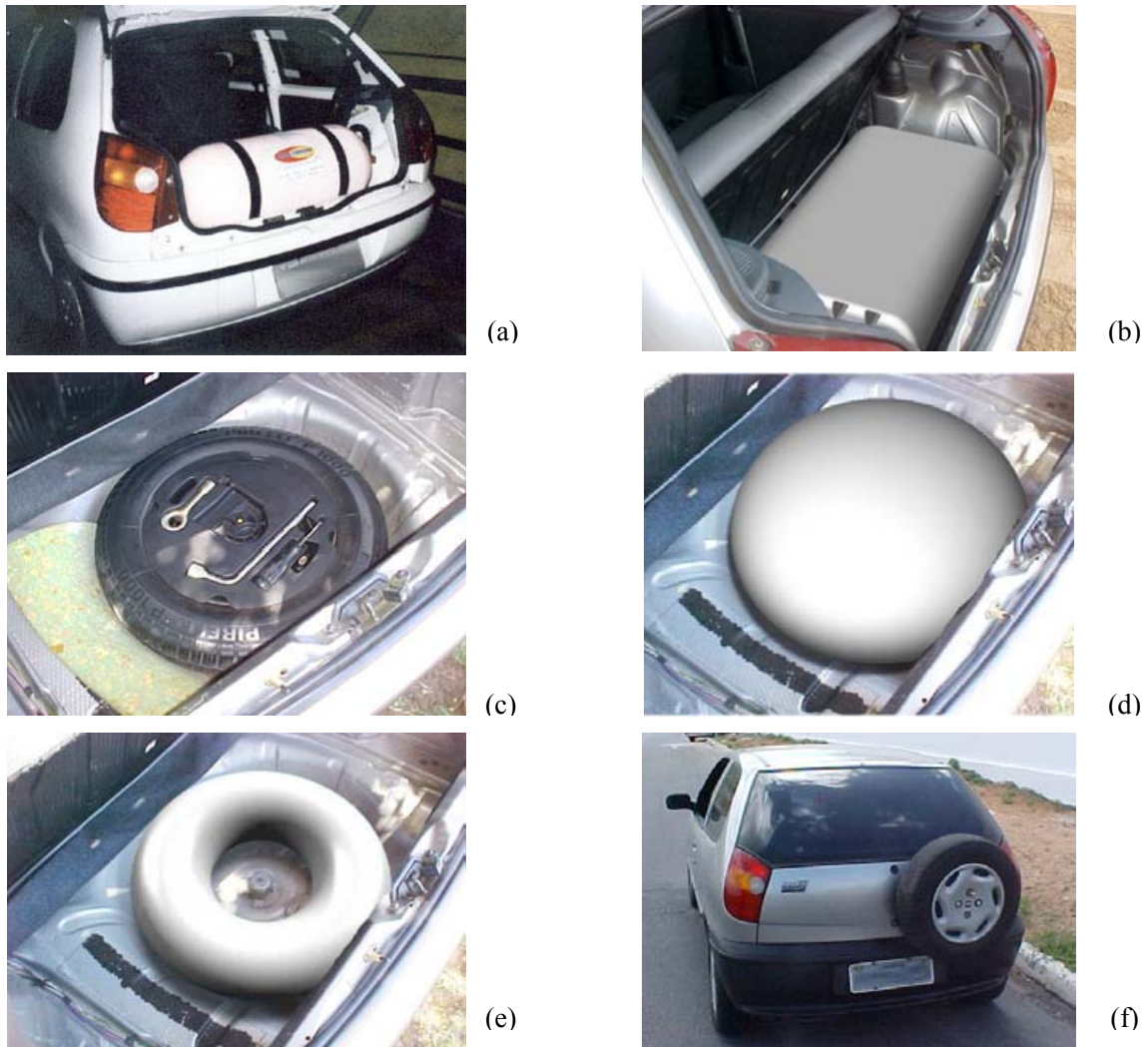
Fig. 6. Fiat Palio EX (a) Porta-malas ocupado pelo cilindro comercial (b) Protótipo de galerias elípticas posicionado no porta-malas (c) Cavidade para o pneu reserva (d) Protótipo elíptico posicionado na cavidade do pneu de reserva. (e) Protótipo toroidal posicionado na cavidade do pneu de reserva. (f) Reposicionamento do pneu de reserva na porta traseira do veículo.
