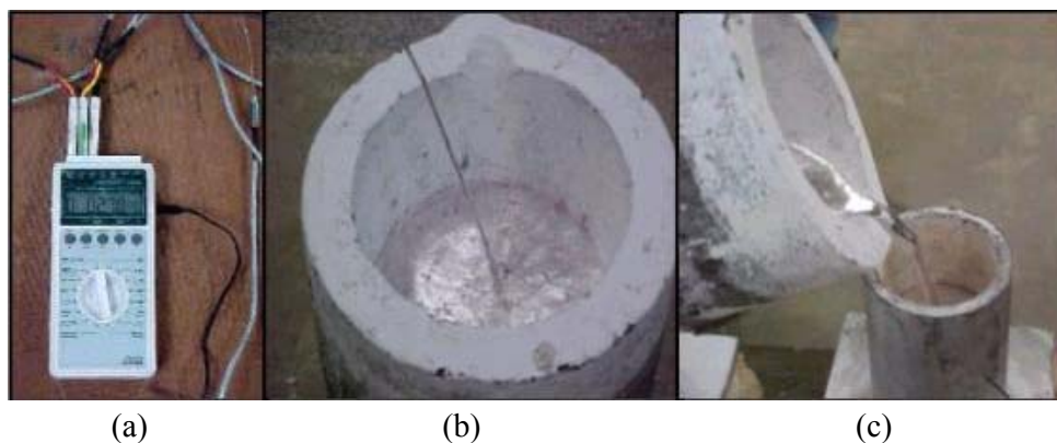
Figura 3. (a) Aquisitor de dados ALMEMO com os termopares conectados; (b) cadinho com o termopar no metal líquido antes do vazamento; (c) foto mostrando vazamento da liga na lingoteira.
