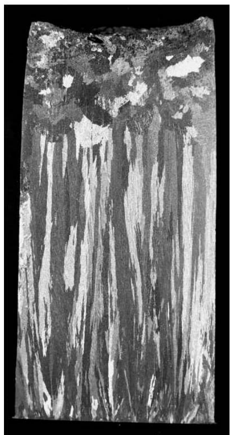
Figura 5. Macroestruturas: (A) Al-3%Si; (B) Al-5%Si, (C) Al-7%Si e (D) Al-9%Si, molde de aço inoxidável. Aumento 0,70X.
