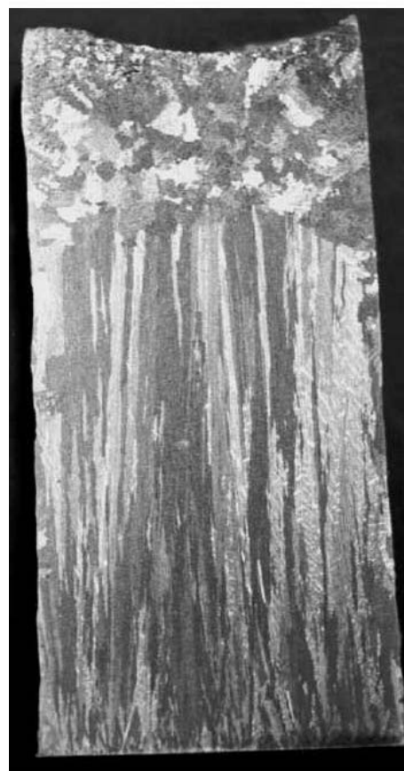
Figura 5. Macroestruturas: (A) Al-3%Si; (B) Al-5%Si, (C) Al-7%Si e (D) Al-9%Si, molde de aço inoxidável. Aumento 0,70X.
