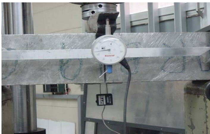
Figura 3.2. Detalhe do posicionamento dos extensômetros
