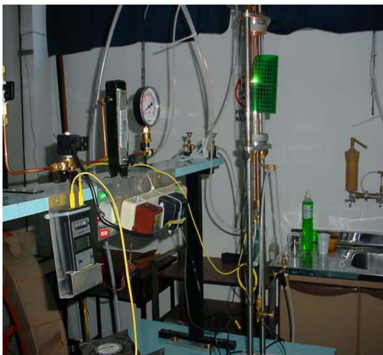
Figura 3. Reator de filamento quente utilizado para a deposição dos filmes de diamante CVD.
