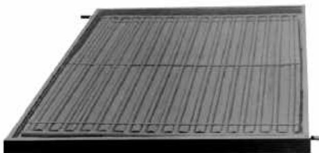
Figura (1). Coletor aletado em estudo com novo modelo de configuração proposto
