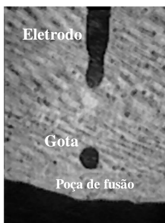
Figura 1. Exemplo de imagem típica de transferência metálica, destacando os elementos poça de fusão, gota e eletrodo
