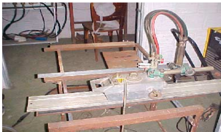
Figura 2. Sistema desenvolvido para a automatização do processo de soldagem.
