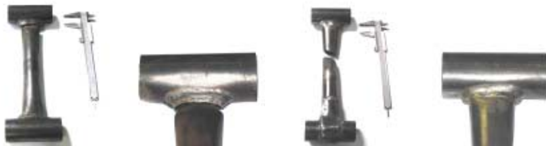
Figura 8. Fotos dos corpos de prova usados para o ensaio de tração soldados manualmente em (a) e soldados pelo robô (b).
