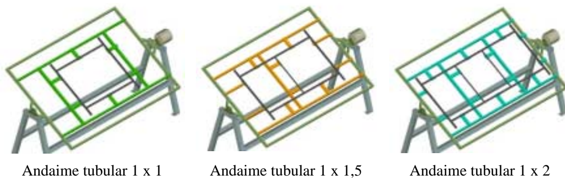
Figura 4. Desenho renderizado do gabarito com os andaimes tubulares .
