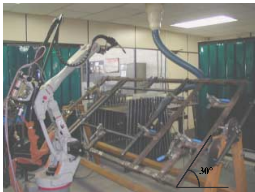
Figura 5. Foto mostrando o gabarito com o andaime tubular 1 x 1 posicionado para a soldagem.
