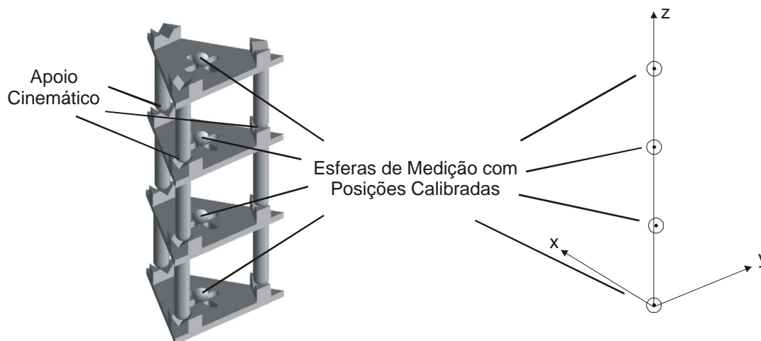
Figura 2. Concepção do Padrão vertical desmontável
