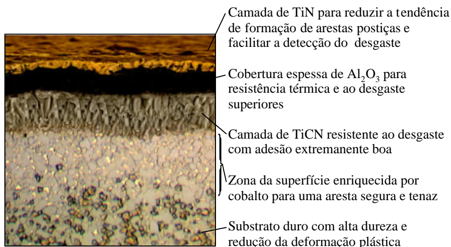
Figura 1. Combinação de revestimentos para boas condições de usinagem (Sandvik, 2000).
