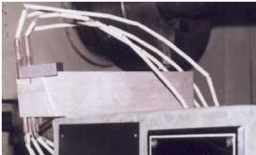
Figura 2. Foto do dispositivo porta ferramentas projetado para medir a temperatura.
