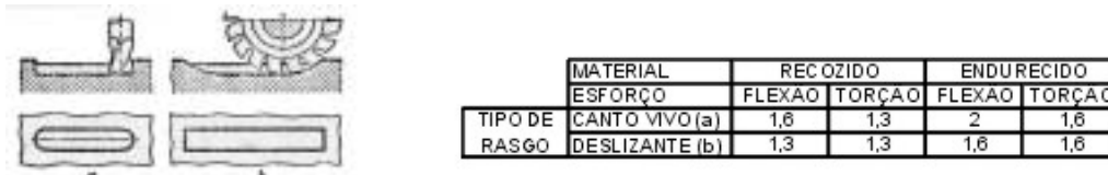
Figura 8. Tabela de valores de k_f para diferentes tipos de rasgos de chavetas.
