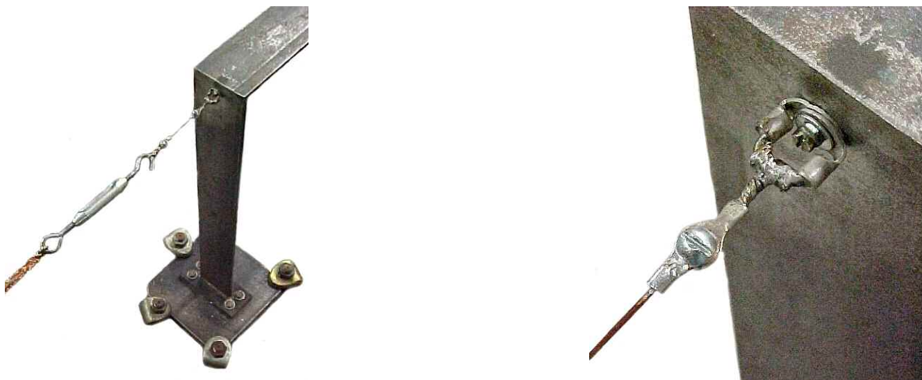
Figura 5: Dispositivo para impor deslocamentos à estrutura ( no canto esquerdo, detalhe da fixação à coluna).
