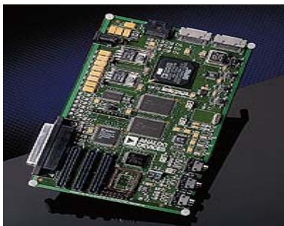
Figura 2.3. Placa ADSP-21160 EZ-KIT Lite da Analog Device
