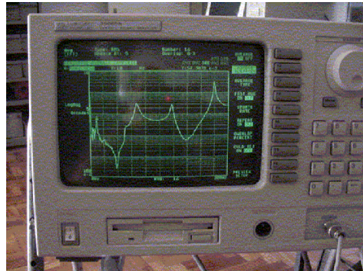
Figura 2.2. Analisador dinâmico de Fourier
