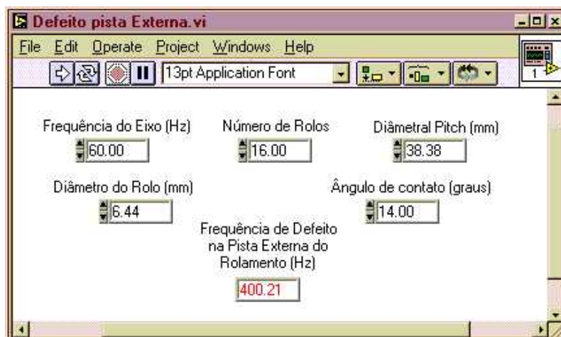
Figura 1. Painel frontal do programa LabVIEW para cálculo da frequência característica de defeito.
