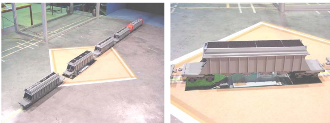
Figura 2. Vista do modelo da composição na secção de trabalho do túnel aerodinâmico (incidência do escoamento paralela ao eixo da composição).
