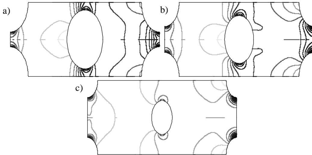
Figura 4. Campos de pressão ( $Re_H = 1.67 \times 10^5$ ): a)  $\phi = 0.70$ , b)  $\phi = 0.80$  e c)  $\phi = 0.90$ .
