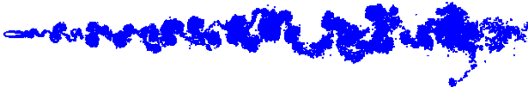
Figura 1. Esteira de vórtices do aerofólio NACA0018 isolado com t = 27,0 e \sigma_0 = 0,005
