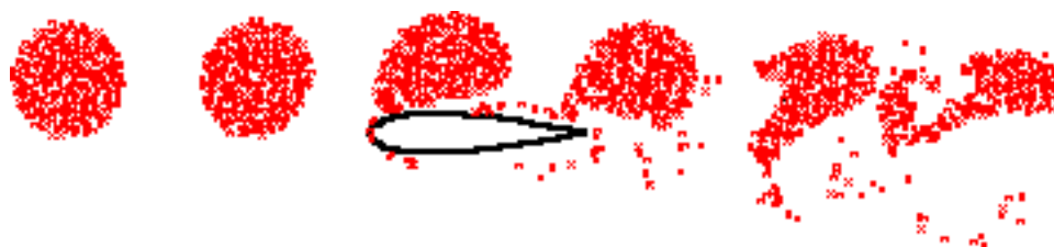
Figura 4. Passagem da nuvem pelo aerofólio, relativa aos avanços 420, 440, 460, 480, 500 e 520 correspondendo aos instantes 18,9, 19,8, 20,7, 21,6, 22,5, e 23,4.
