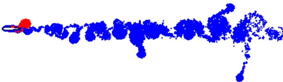
Figura 3. Esteira e nuvem incidente de vórtices, ambos para 480 avanços, correspondendo ao instante t = 21,6 . Nuvem com intensidade dos vórtices igual á 0,00172.
