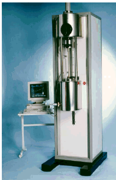
Figura 2. Reômetro capilar ACER 2000 utilizado para caracterização reológica das pastas cerâmicas.
