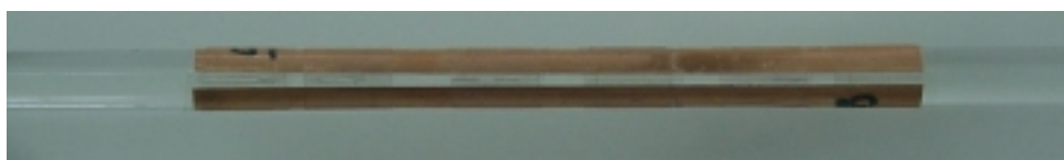
Figura 9. Fixação dos eletrodos no tubo de vidro
