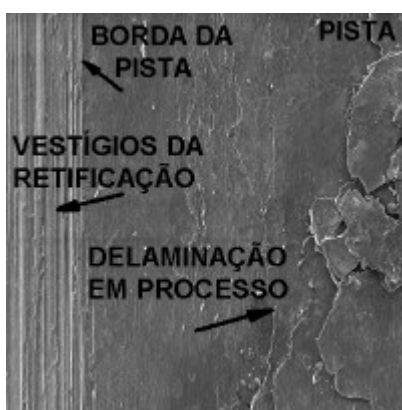
SEM (S.E.) 100 X Borda esquerda da pista: Delaminação
