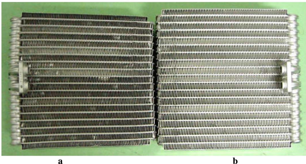
**Figura 01 – Trocador de calor após Brasagem: a) apresentando distorção material nacional; b) sem distorção, material importado.**
