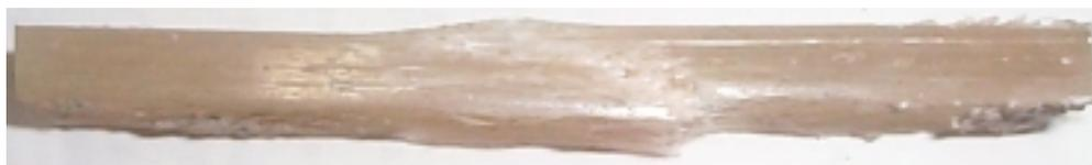
Figura 8. Ruptura do corpo de prova submetido ao ensaio de compressão uniaxial, laminado **C10**
