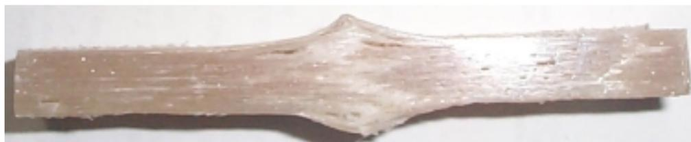
Figura 9. Ruptura do corpo de prova submetido ao ensaio de compressão uniaxial, laminado **C12**
